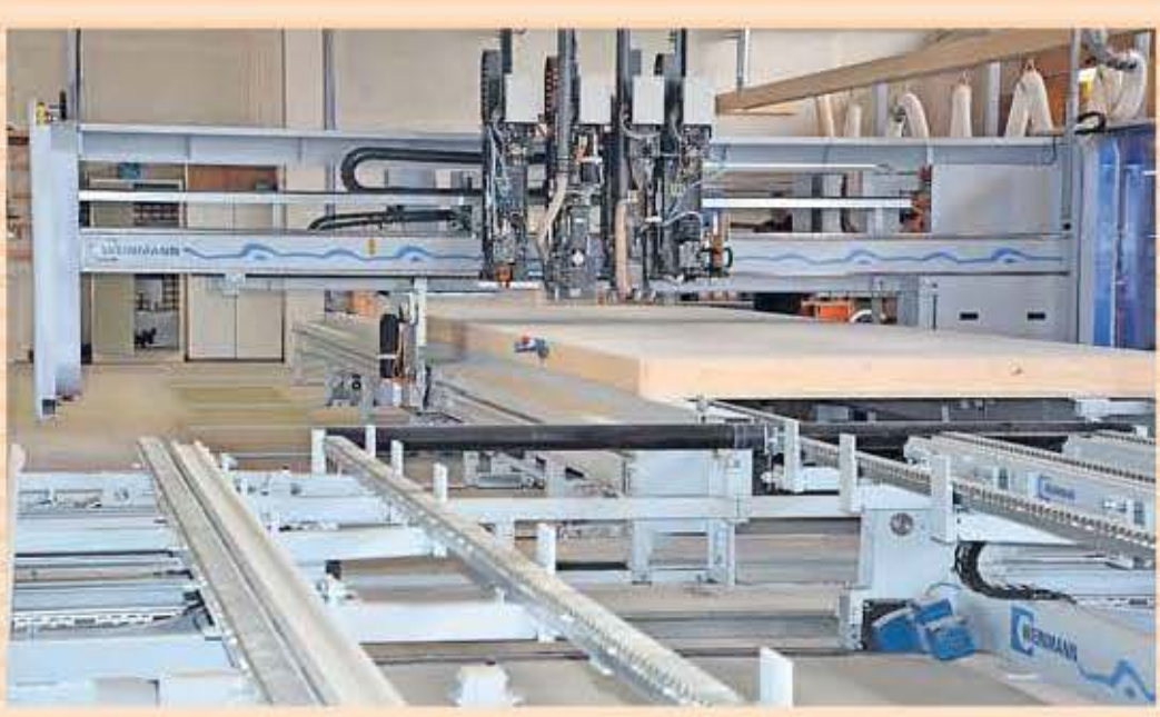
Die neue Fertigungsstraße für den Holzrahmenbau wurde erst im April in Betrieb genommen. Am Wochenende wird die Fertigung kompletter Wände eindrucksvoll vor Ort präsentiert.
